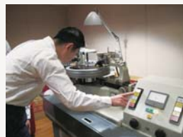
■カッティングマシン ラッカー盤に音を彫る。溝の具合を顕微鏡を使い人の目で丁寧に確認
