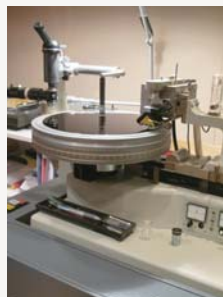
■カッティングマシン ラッカー盤に音を彫る。溝の具合を顕微鏡を使い人の目で丁寧に確認
