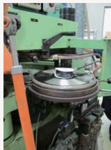
■プレス工程 レコードの原料を手のひら大の塊にし、上下2枚のラベルではさむ（写真右）。これをプレス機（写真左）にセットし圧力でプレス
