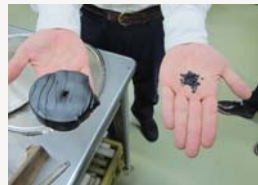
■プレス工程 レコードの原料を手のひら大の塊にし、上下2枚のラベルではさむ（写真右）。これをプレス機（写真左）にセットし圧力でプレス
